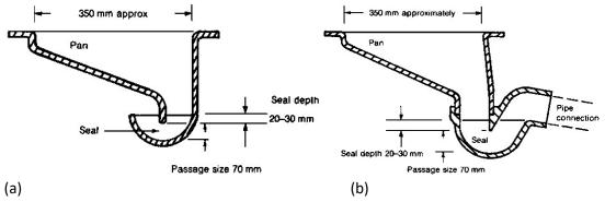
Figure 3.9 Design of a pour flush toilet. (a) Direct Pour Flush; (b) Offset Pour Flush Source: WHO, 1992[10]
